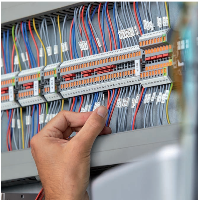
Obr. 1 Na rozdiel od populárnych svoriek PT sa svorky radu PTV vyznačujú bočným vstupom vodiča – výsledkom je jasnejšie pripojenie vodiča a žiadne polomery ohybu.
